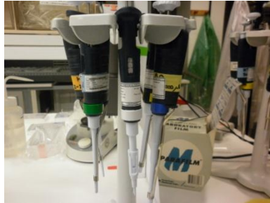
Imatge 3- Micropipetes utilitzades: Gilson P2 (1-2 µl), Gilson P10 (5-10 µl) i Gilson P100 (20-100µl)
