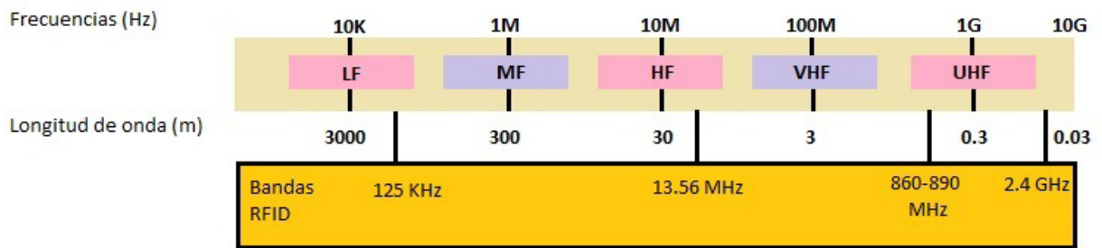
Figura 2.7. Rango de frecuencias reservadas para RFID
