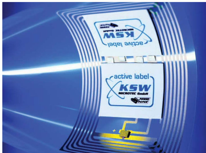
Figura 1.1. Tag RFID con threshold basado en temperatura (6).
