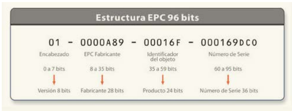
Figura 2.5. Estructura del código EPC (Fuente: GS1 Dominicana).
