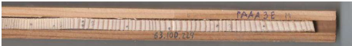
Figura 27. Part d'un testimoni d'un avet de Port Ainé datat. Hi ha un punt cada 10 anys, i dos per marcar cinquanta, aquesta és una tècnica utilitzada per comparar dos testimonis.
