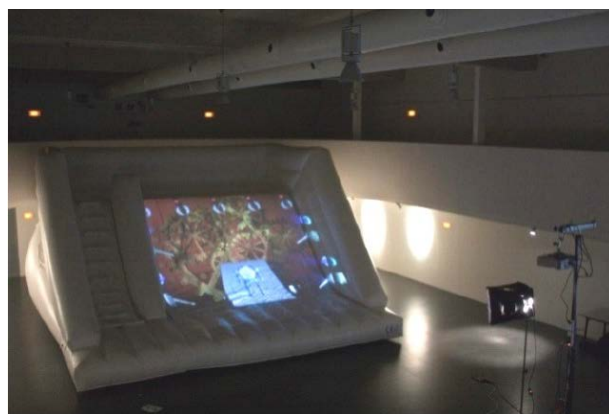
Figura 7 - El tobogán interactivo (izquierda) con el proyector, el sistema de computación, la cámara y luz infrarroja (esquina inferior derecha)
