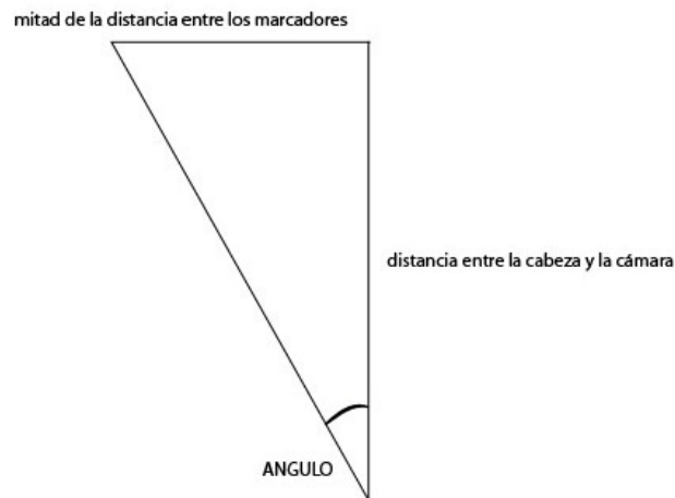
Figura 7 Relación entre la distancia de los marcadores y la distancia de la cabeza con la cámara
