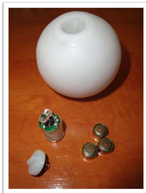
Figura 38 Esfera iluminada desmontada
