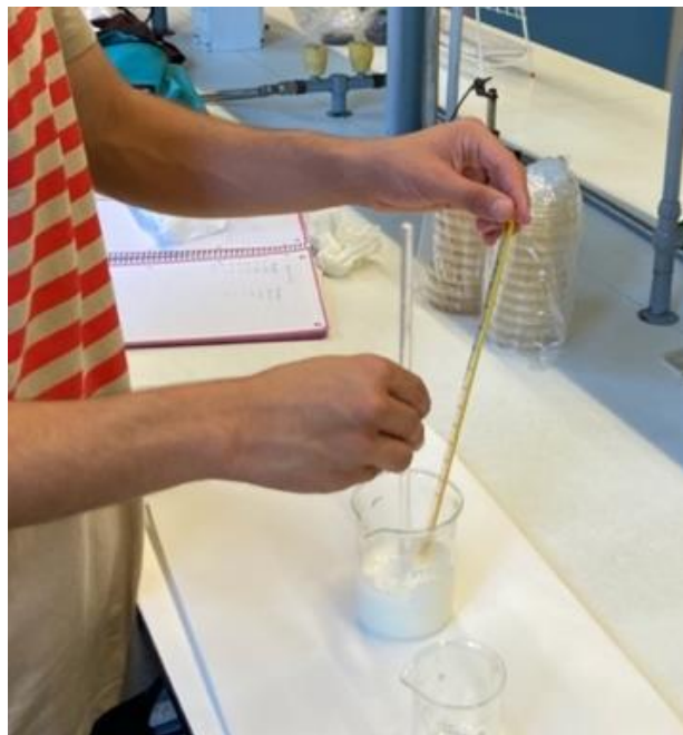
Imatge 29: integració d'ambdues fases amb la vareta de vidre vigilant la temperatura
