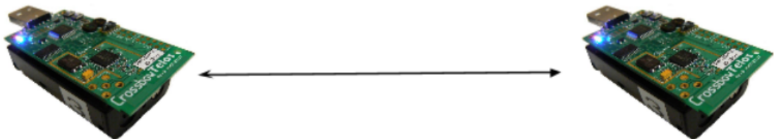
FIGURA 4.4: Exemple gràfic connexió bidireccional de dos TelosB
